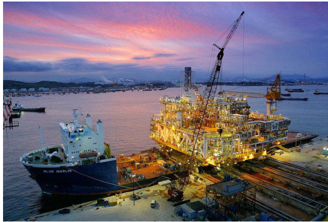
Рис. 1. Вивантаження надважкого вантажу по рейках на берег
