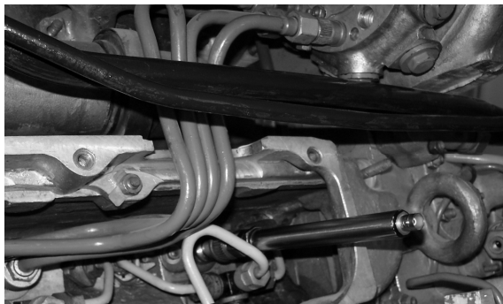
Рис. 2. Установлення п'єзодатчика тиску на місці клапана повітропуску
