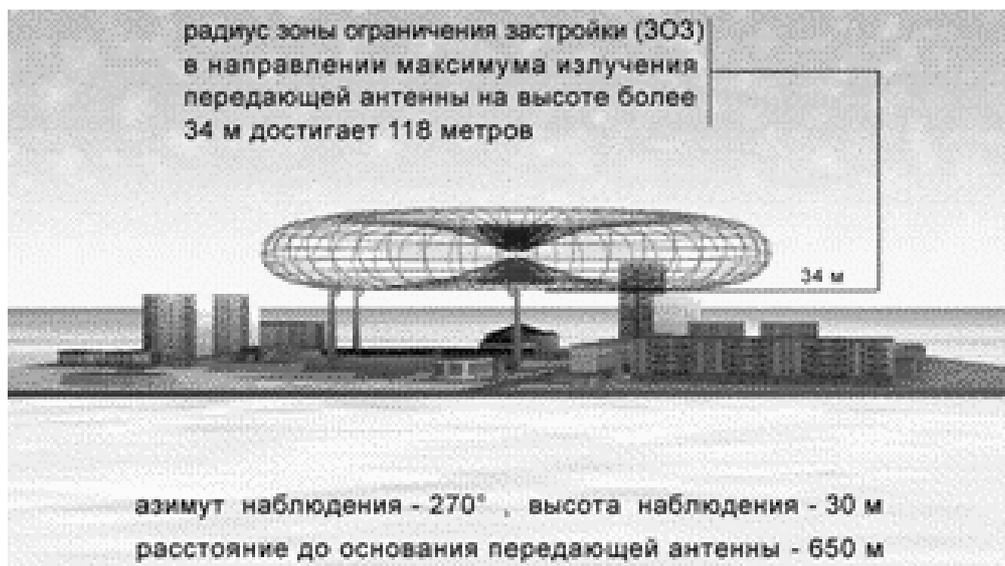
Рис. 2. УКВ-ФМ радиовещательная станция ТРК "Аллюр";
