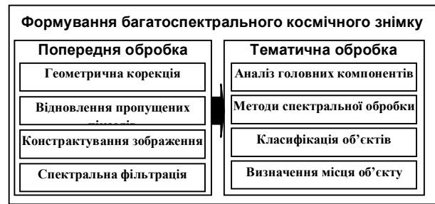
Рис. 2. Основні етапи формування багатоспектрального космічного знімку
