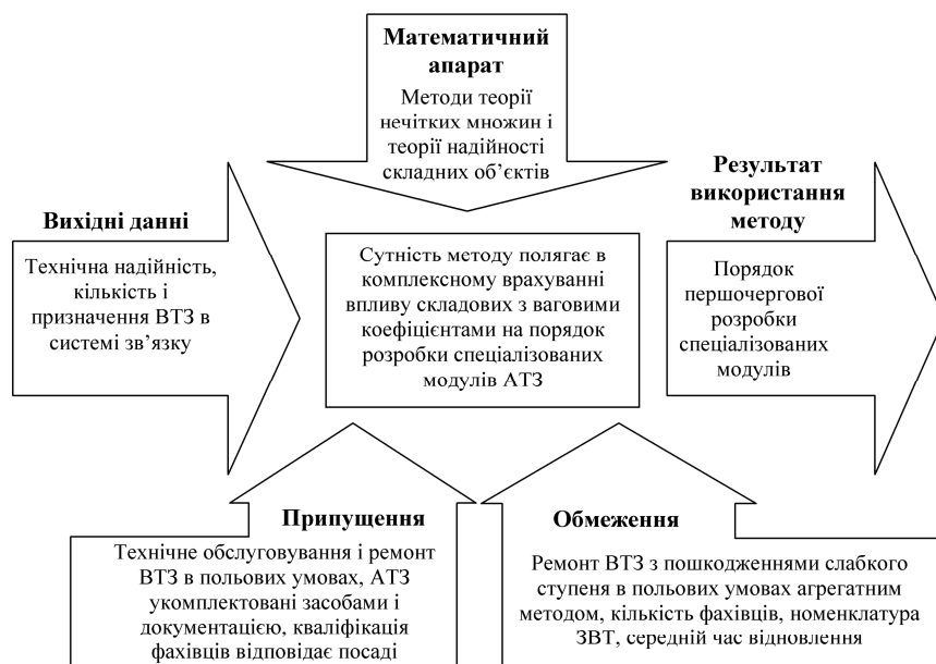
Рис. 1. Структура методу обґрунтування розробки першочергових спеціалізованих модулів апаратних технічного забезпечення військової техніки зв'язку
