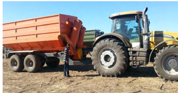
Рис. 3. Транспортно-технологічний агрегат Challenger MT685D + ПБН – 30 (транспортування насіння соняшника)
