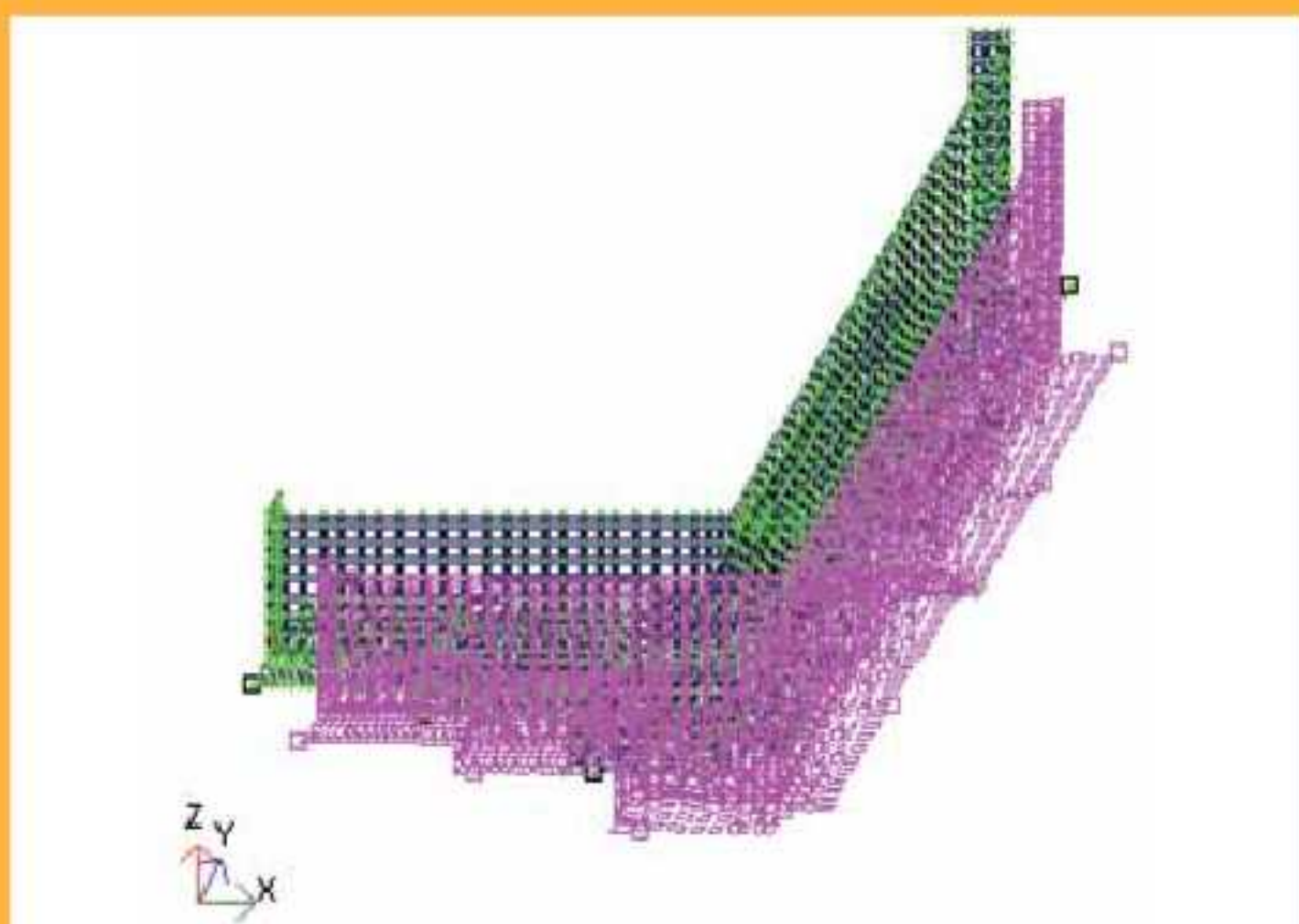
Рис. 4. Общий вид начальной и деформированной стадии расчетной модели стенки (вариант 1.2)
