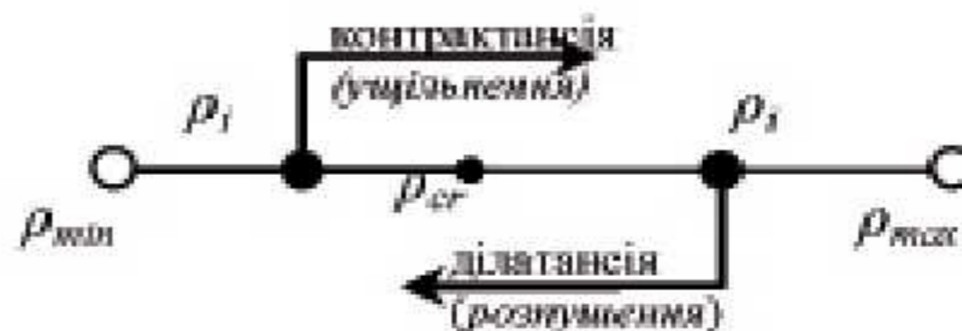
Рис. 3. Схема ефекта контрантансії і дилатансії в ґрунтах
