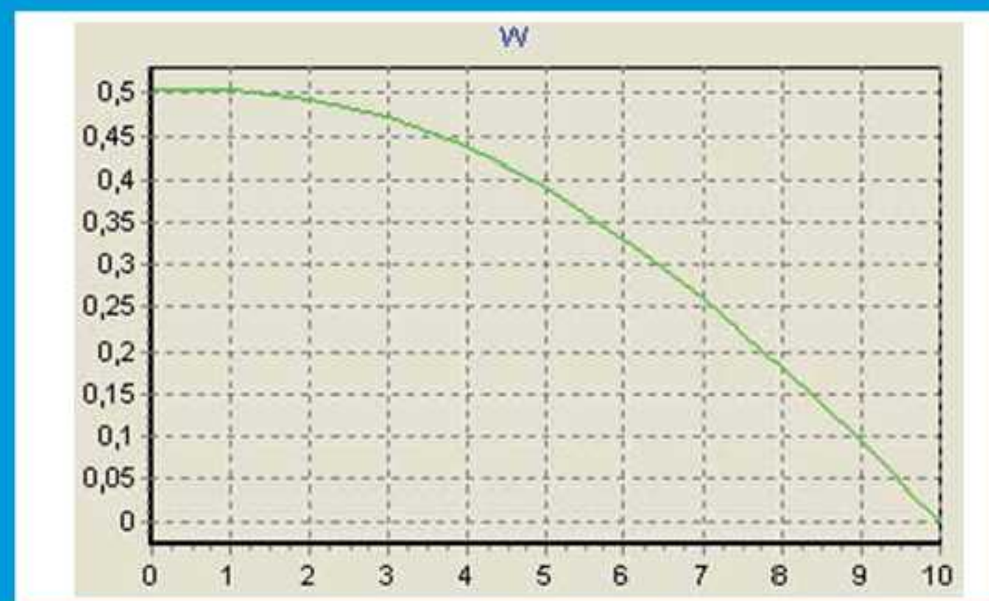
Рис. 7. Вертикальні переміщення W через 10 днів після пониження рівня ґрунтових вод у горизонтальних дренажах
