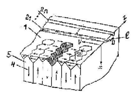
Рис. 4. Характер формирования зигзагообразной доменной структуры в системе координат X, У, Z при нанесении параллельных царапин 21...2n на поверхности ферромагнетика 1.3 – зигзагообразные домены 2, с углом зигзага ω; 4 – вектора доменов 5 в направлении оси X; *l* – расстояние между царапинами.
