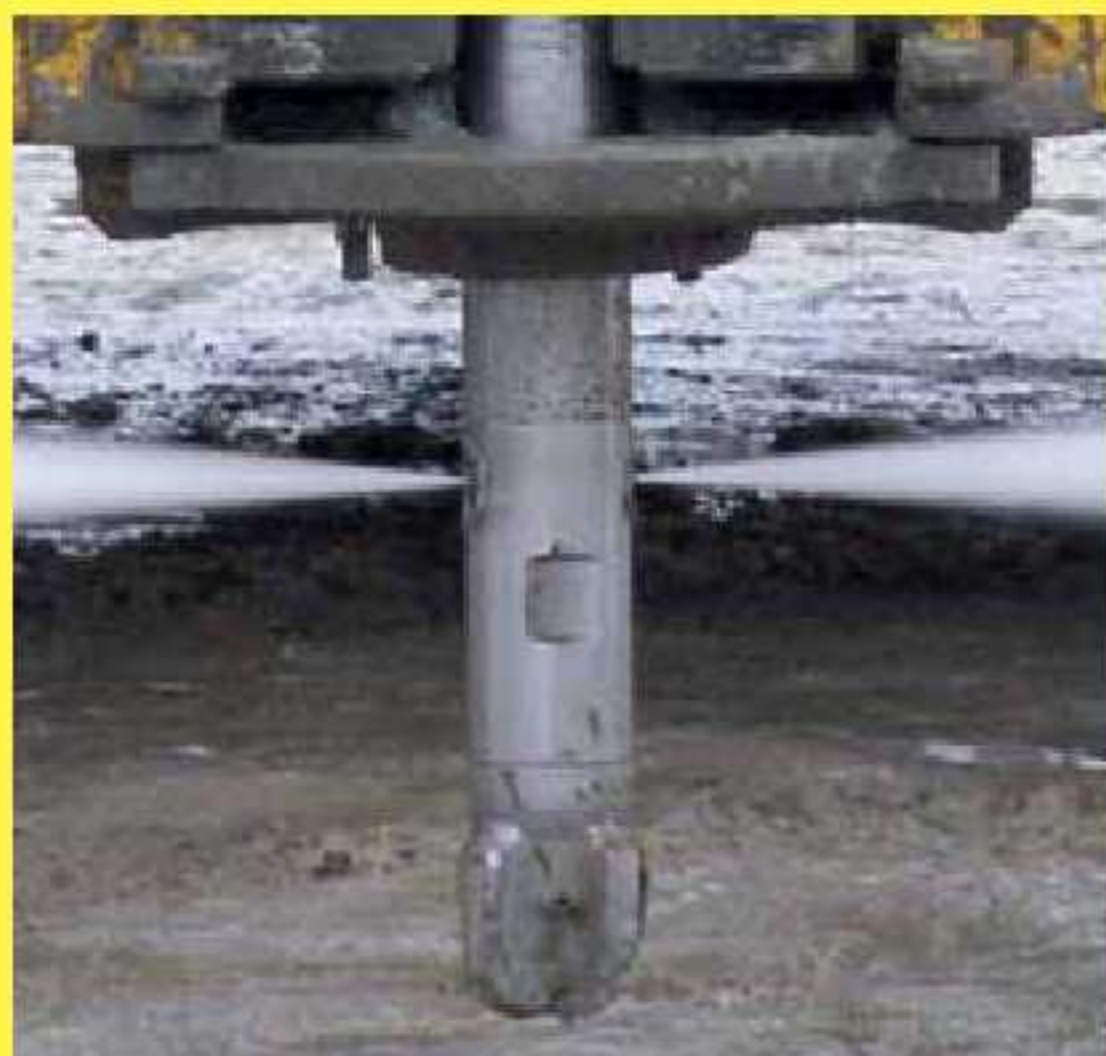
Рис. 1. Конструкция гидромонитора и буровой коронки
