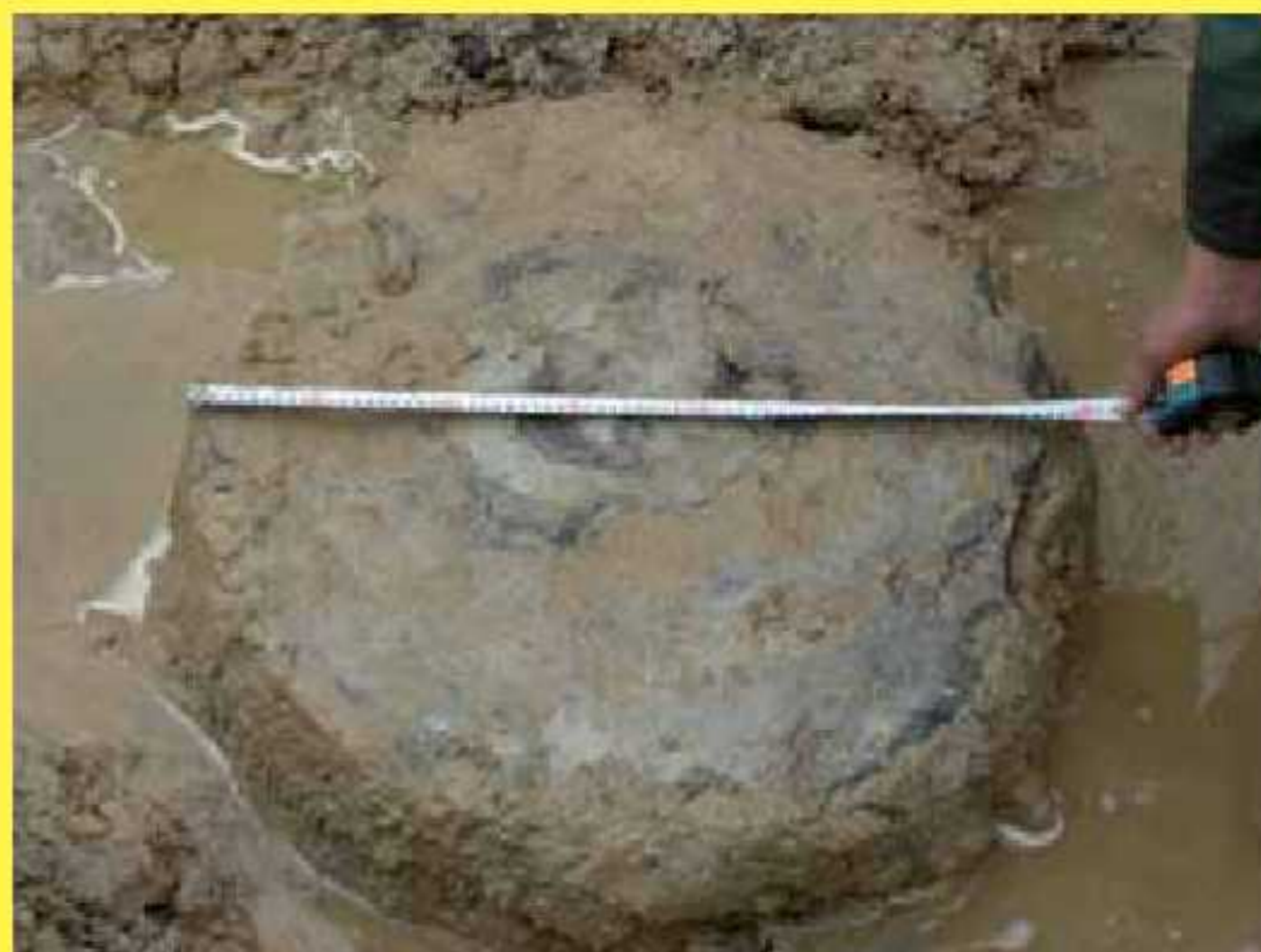
Рис. 2. Колонна струйного инъецирования
