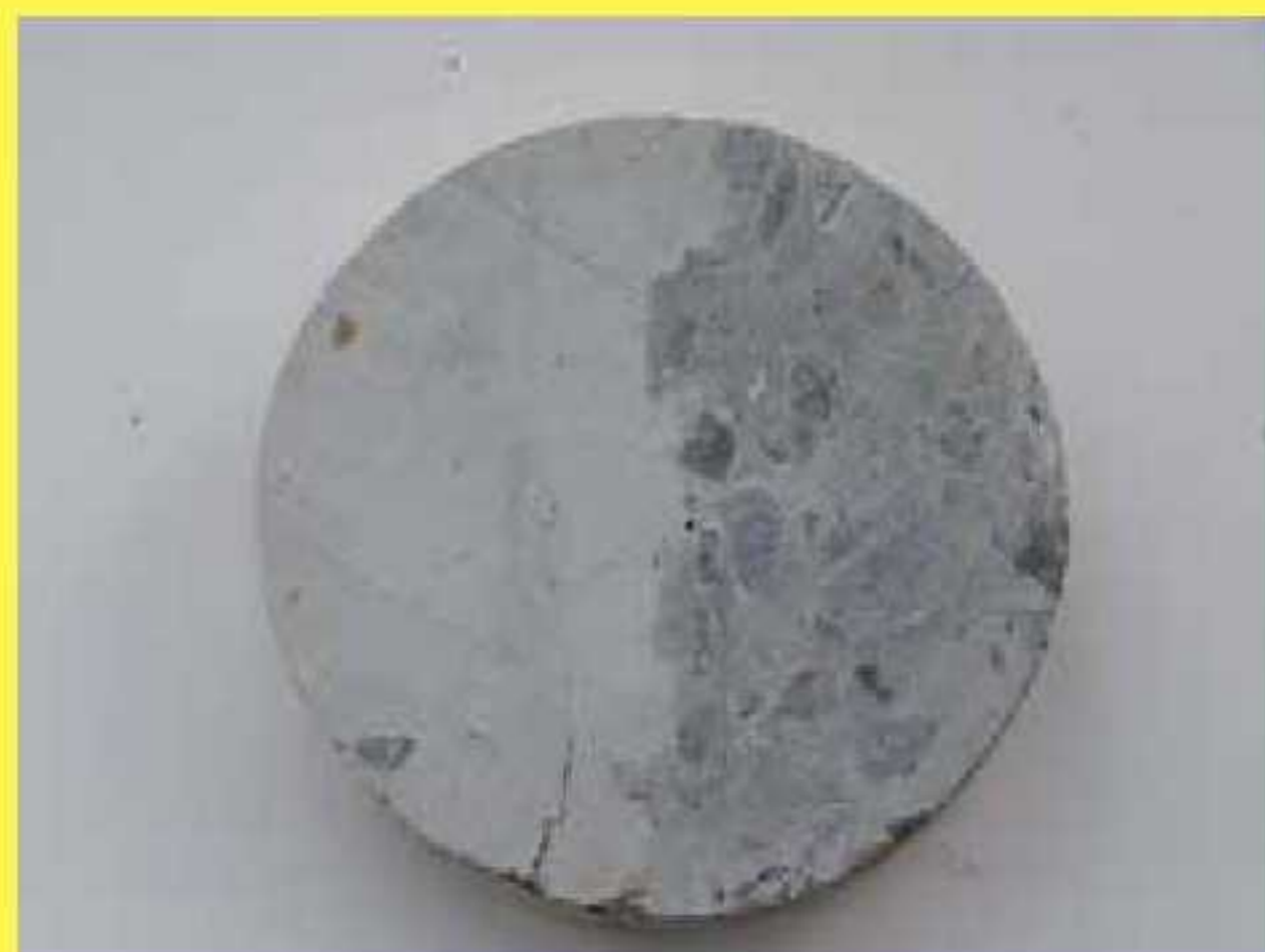
Рис. 6. Поперечный разрез выбуренного керна
