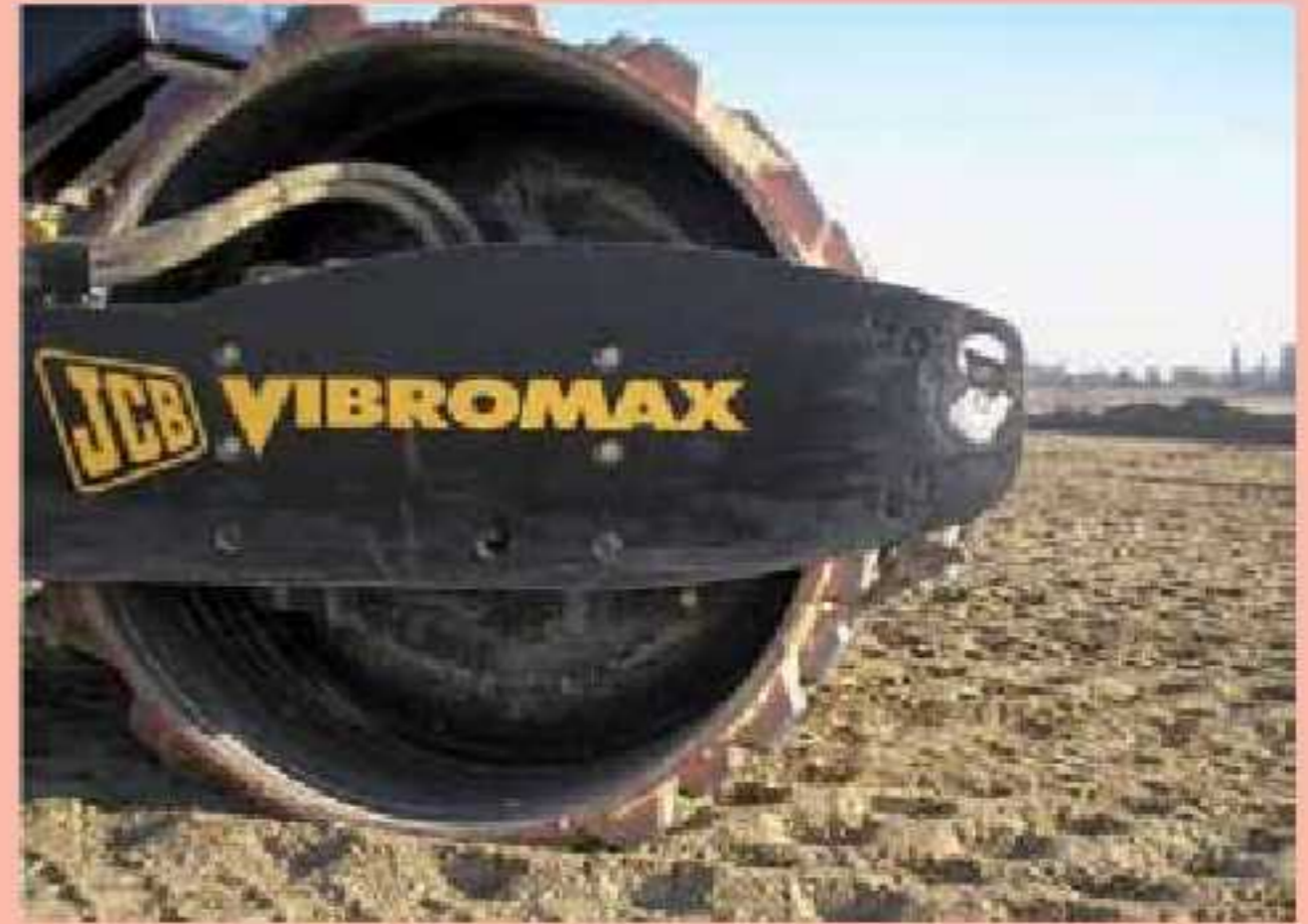
Рис. 2. Дослідні об'єкти в процесі їх зведення: а – ущільнення ґрунту важкими трамбівками (об'єкт № 2– ґрунтова подушка під резервуар); б – ущільнення ґрунту вібраційними котками (об'єкт № 3 – штучний насип площею 190 га і висотою 3...6 м)
