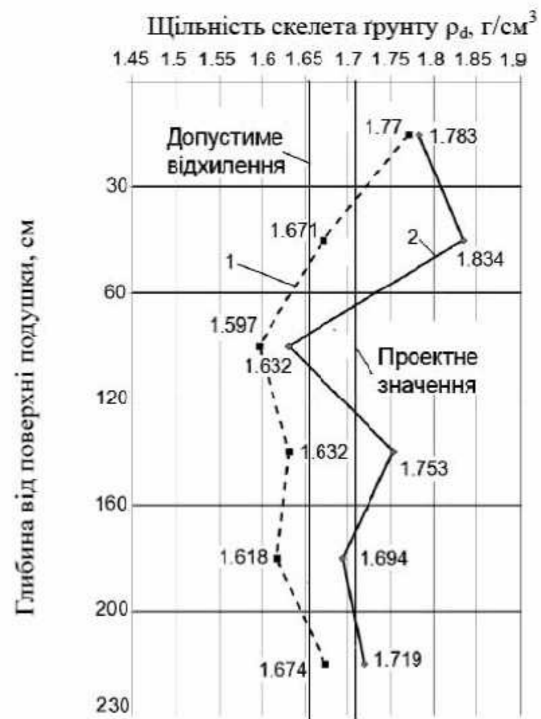
Рис.4. Графіки зміни щільності скелета ґрунту за глибиною ущільненої подушки самохідним котком у вібраційному та статичному режимах роботи за 8 проходів одним слідом: 1 – у статичному режимі роботи; 2 – у вібраційному режимі роботи
