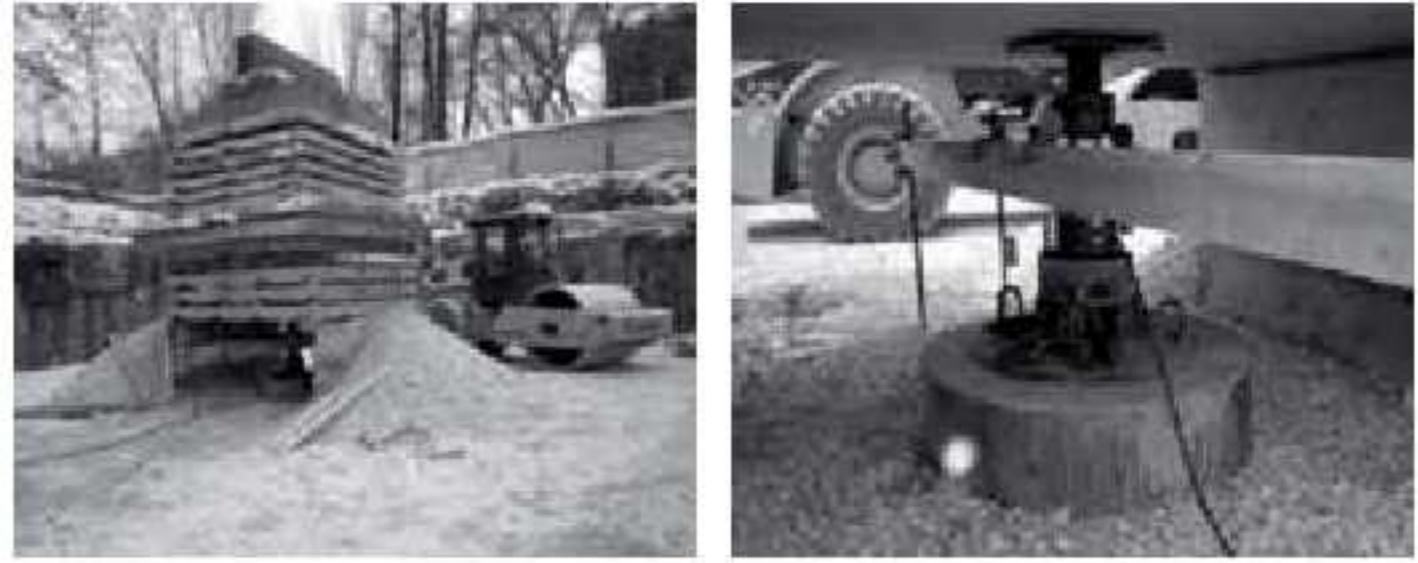
Рис. 7. Натурные штамповые испытания закрепленного грунта
