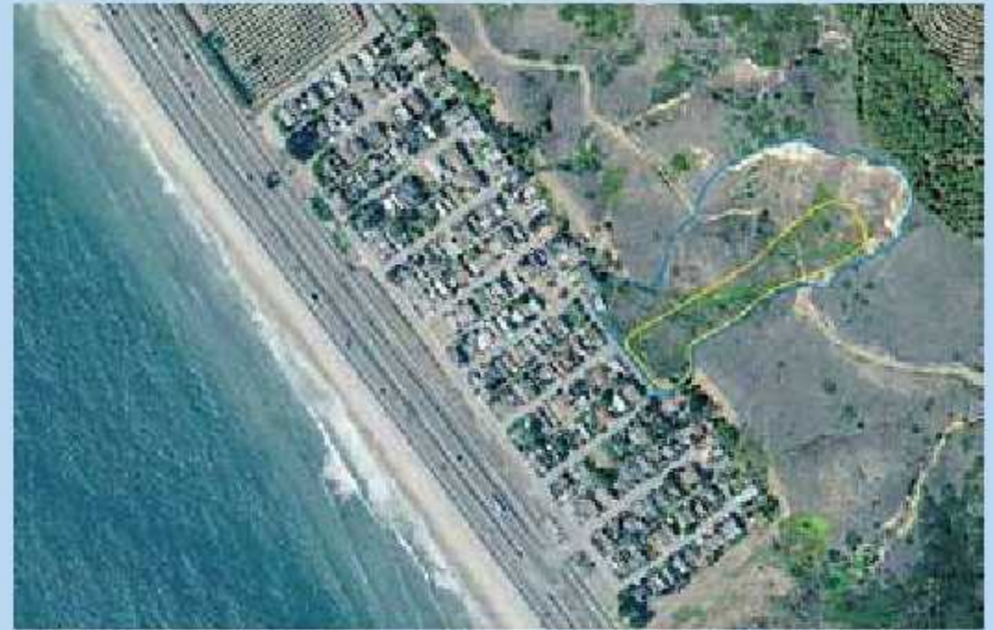
Рис. 2. Приклад аерофотознімки зсуву Ла Кончіта у штаті Каліфорнія, США, прийнятий у 2005 році. Синя лінія окреслює старіший зсув, жовта лінія – недавній зсув. (Фото люб'язно надано агенцією аерознімків США й округом Вентура, штат Каліфорнія, і Randy Jibson, геологічна служба США [14])
