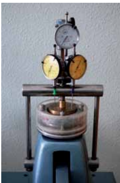
Рис. 2. Кольцо одометра со специальным штампом, для использования дополнительных (винтовых) марок.
