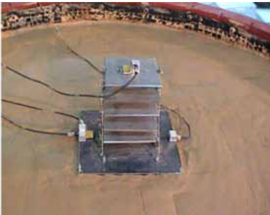
Рис. 4. Реализация экспериментального исследования модели 5-этажного здания на грунте.
