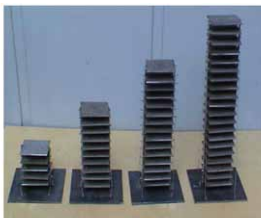
Рис. 2. Внешний вид 5, 10, 15, 20-этажных моделей зданий.
