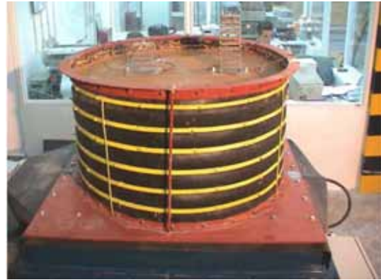
Рис. 5. Реализация эксперимента при исследовании взаимодействия двух моделей зданий.
