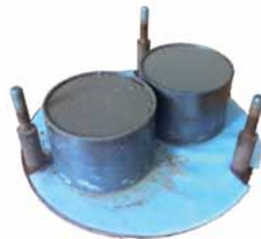
Рис.1. Зменшення висоти і діаметру зразка в процесі синерезису в процесі вакуумування в стані тиксотропного спокою.
