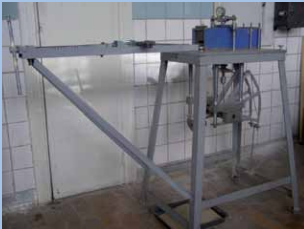
Рис. 4. Загальний вигляд зсувного приставу ПСГ-2М в комплекті з приставкою.
