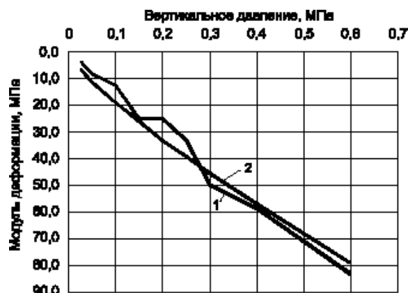
Рис.5. Одометрические модули деформации: 1 – полученный по лабораторным данным; 2 – вычисленный по формуле (3).
