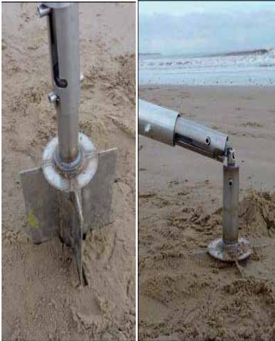
Рис.5. Анкерная свая Greenstick с крыльями: перед (слева) и после (справа) погружения.
