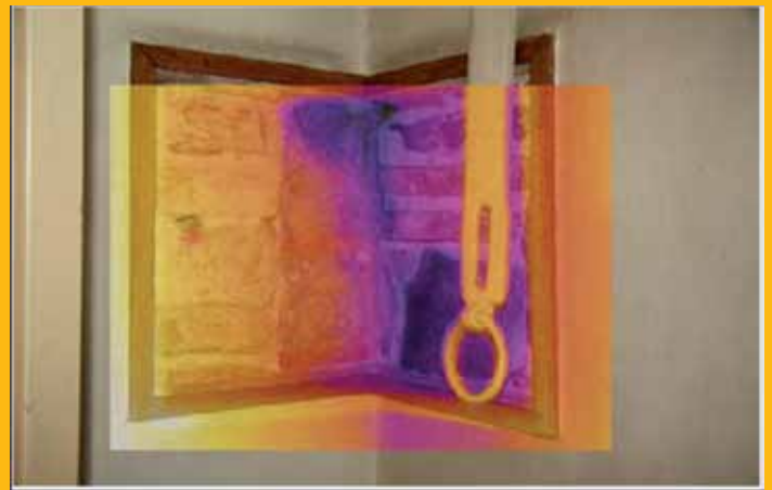
Рис. 4. Мережа прихованих тріщин, зондаж мурування Софійського собору (термографія)
