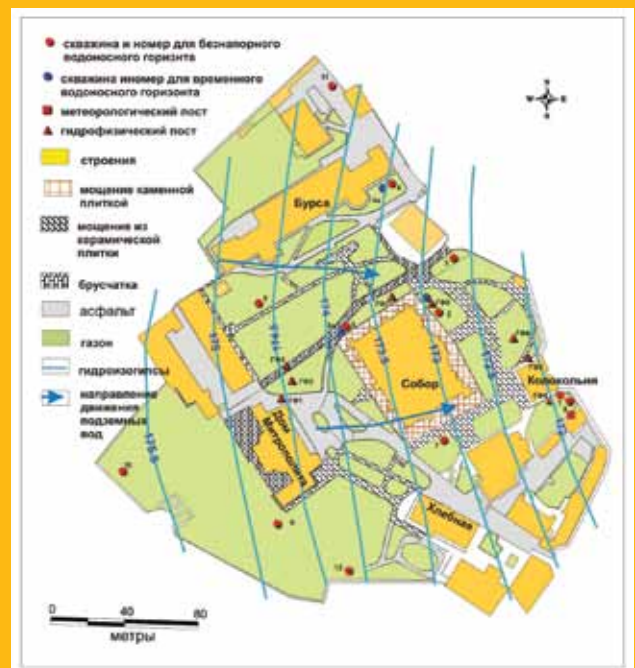
Рис. 2. Схема розміщення гідрогеологічних пунктів спостереження на території ансамблю споруд Софійського собору; ізолінії УГВ в 2014 г.
