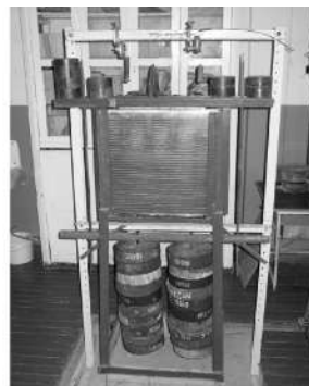
Рис 2. Лоткові статичні випробування моделей НППС у складі стрічкового ростверку: а) схема; б) загальний вигляд; 1 – лоток; 2 – ростверк; 3 – моделі НППС з розширеннями; 4 – система навантаження; 5 – прогиноміри; 6 – реперна рама; 7 – підвіски з вантажами.
