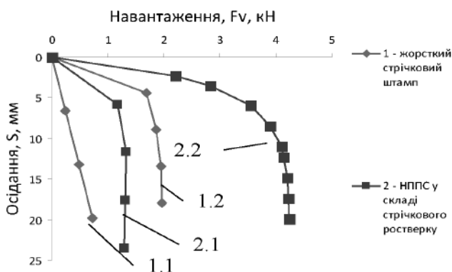
Рис 15. Графіки 2D-моделювання МСЕ: 1.1 – жорсткого стрічкового штамп при щільності скелету ґрунту \rho_d = 1,45 \text{ г/см}^3 ; 1.2 – жорсткого стрічкового штамп при \rho_d = 1,55 \text{ г/см}^3 ; 2.1 – НППС у складі стрічкового ростверку при \rho_d = 1,45 \text{ г/см}^3 ; 2.2 – НППС у складі стрічкового ростверку при \rho_d = 1,55 \text{ г/см}^3 .
