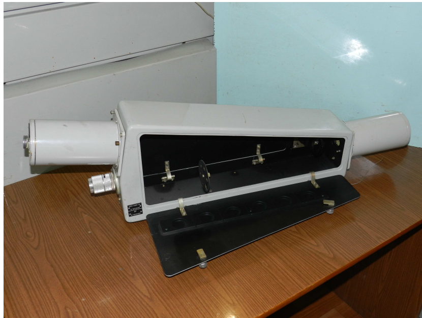
Рис.2 – Оптический блок измерителя длительности на основе нелинейного кристалла и двух измерителей энергии люминесцентного типа на длины волн 1,06 мкм и 0,53 мкм
