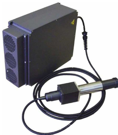
Рис.4 - Волоконный лазер ИЛМИ-1-50. Средняя мощность в излучении может быть 10, 20 и 50 Вт, энергия в импульсе 0,5 и 1 мДж, частота следования импульсов от 20 до 200 кГц, длина выходного волокна 3 м
