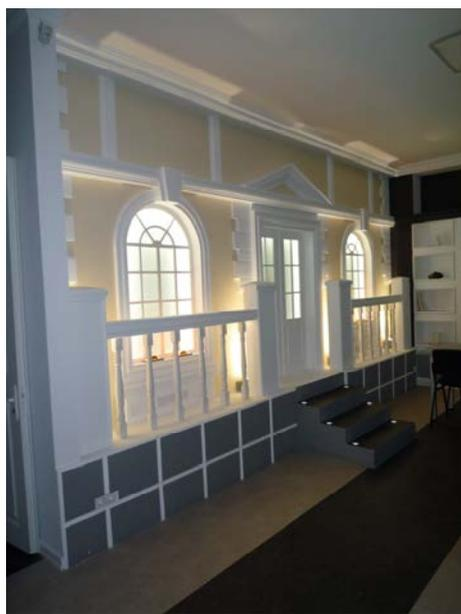
Лабораторный комплекс содержит масштабные макеты колоннады и фасада здания, оснащенные стационарной системой освещения, позволяющие создавать различные сценарии подсветки. Для исследования оптических характеристик техники освещения предусмотрена система спускных треков с разными
