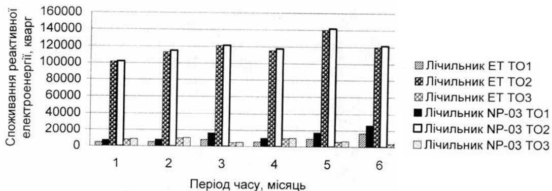
Рис. 6 – Порівняльна характеристика реактивної ЕЕ при індуктивному характерові навантаження, виміряна 2- та 3-елементними ЛЕ по ТО за період дослідження
