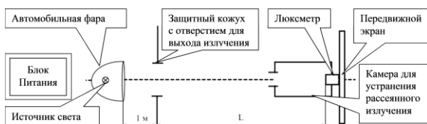
Рис. 1 – Схема стенда ННЦ «Институт метрологии»
