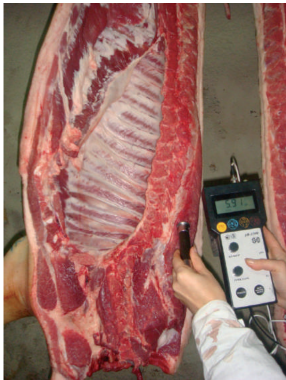
Рис.1. Вимірювання показника електропровідності в різних м'язах туші приладом LF-Star CPU-Pistole.
