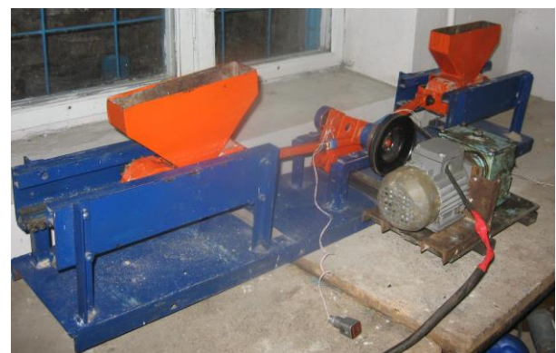
Рис. 3. Фізична модель роликівальної формувальної установки з рекуперативним приводом
