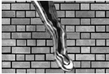
Рис. 6 Представлення розподілу градієнта вздовж дефекта
