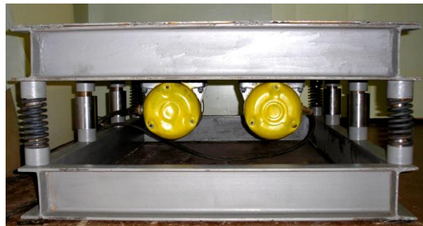
Рисунок 5. Опытно-промышленный образец виброплощадки с жестко-упругими ограничителями грузоподъемностью 1500 кг.
