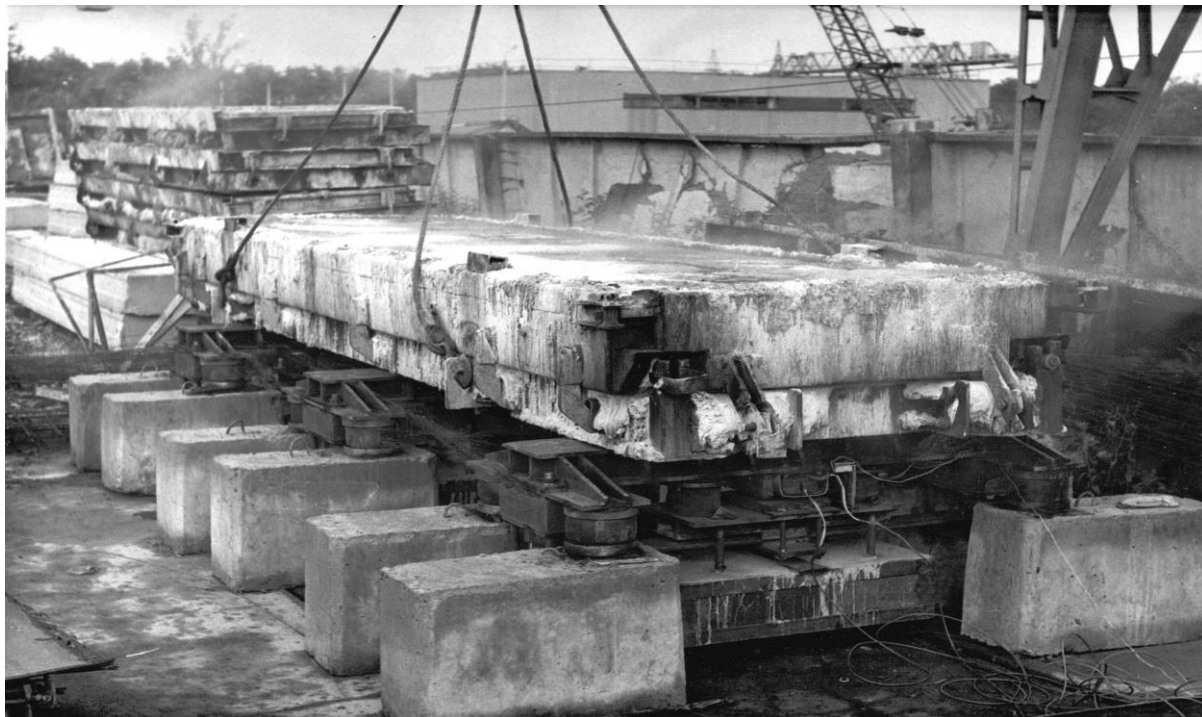
Рисунок 6. Загальний вигляд електромагнітного вібромайданчика (впроваджено на заводі ЗБК м. Бровари, Київської області).
