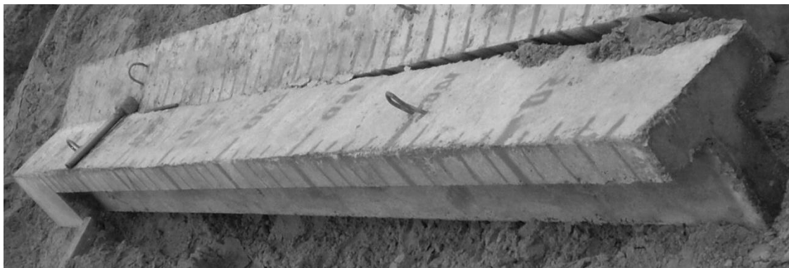
Рисунок 1. Дослідна паля таврового поперечного перерізу.
