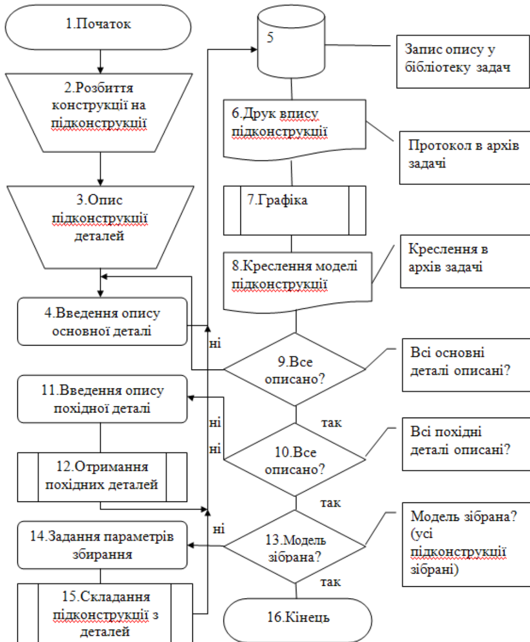
Рисунок 1. Блок – схема алгоритму формування складних скінченно – елементних моделей автокранів.
