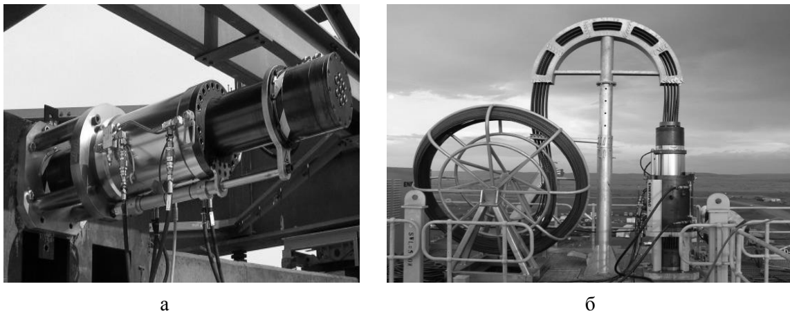
Рисунок 3. Тросовий гідродомкрат (9 типових розмірних марок від HL45 до HL821 вантажністю від 45т до 821т): а – загальний вигляд; б – у робочому стані з пристроєм для намотування тросу.
