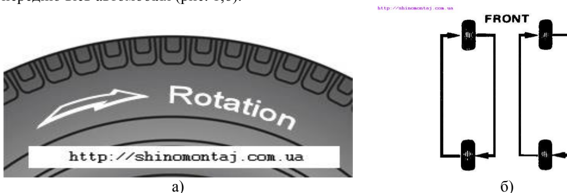
Рисунок 1. Схема перестановки шин із вказаним напрямком обертання: а) позначення на шині; б) схема перестановки шин.
