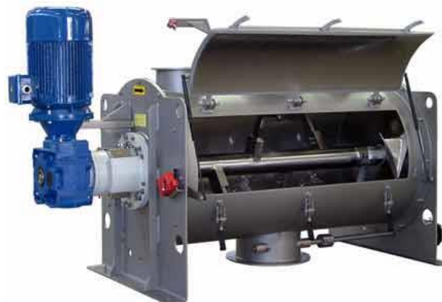
Рисунок 1. Горизонтальний центрифужний змішувач.
