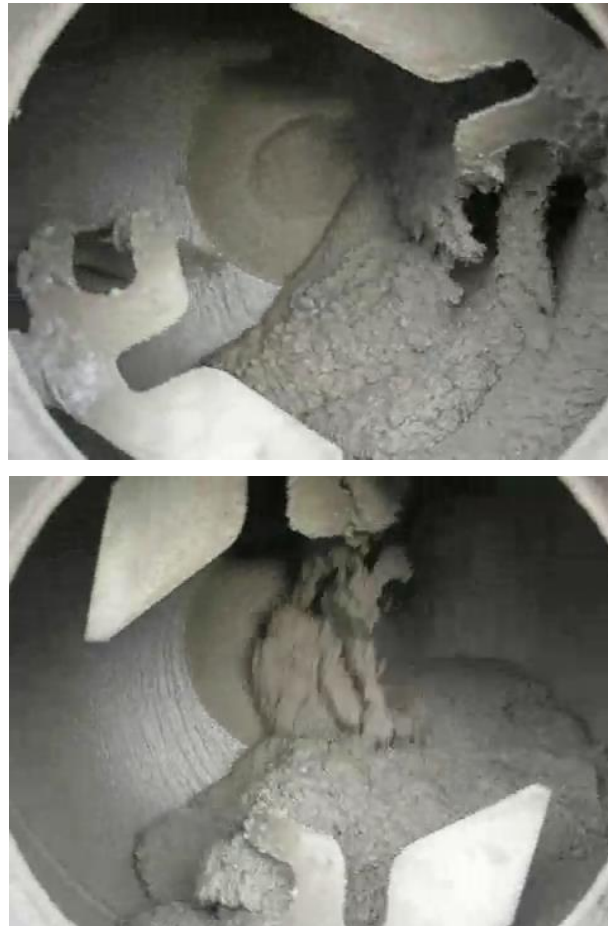
Рисунок 4. Рух суміші по лопаті ламаної конструкції із круговими отворами і поздовжніми пазами.
