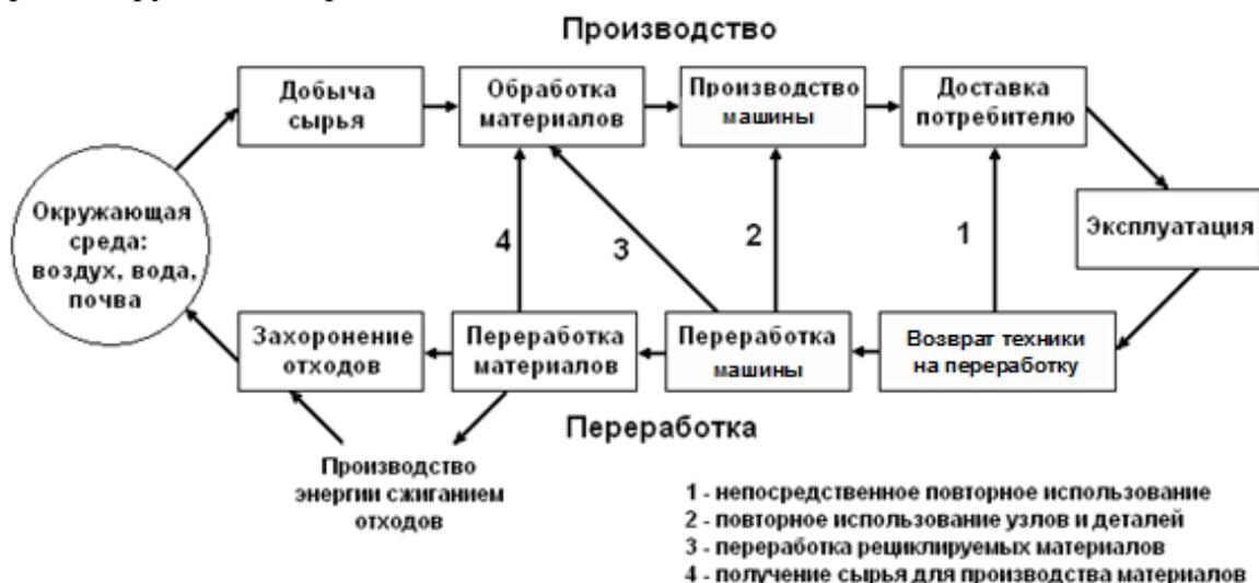
Рис. 1 - Схема жизненного цикла машины с учетом использования рециклированных материалов
