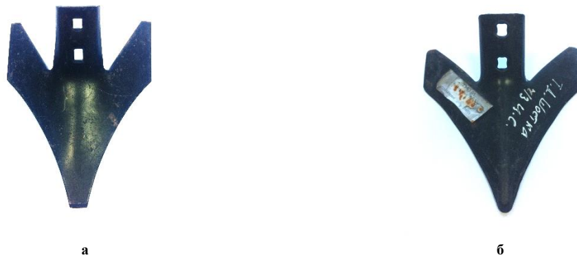
Рис. 1 - Внешний вид исследуемых лап: а -MARATHON SERIES фирмы OSMUNDSON; б - 9.3" TigerMate II фирмы CNH
