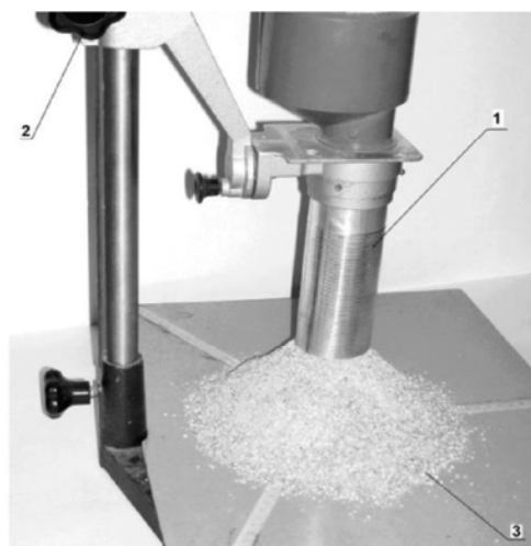
Рис. 3 – Прилад для визначення кутів природного укусу сипучих матеріалів: 1 – порожнистий циліндр; 2 – механізм піднімання циліндра; 3 – площина з розміткою
