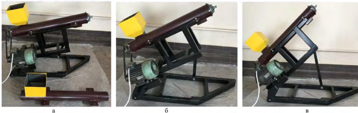
Рис. 2 – Загальний вигляд розташування гвинтового робочого органу до горизонту: а – 15°; б - 30°; в - 60°
