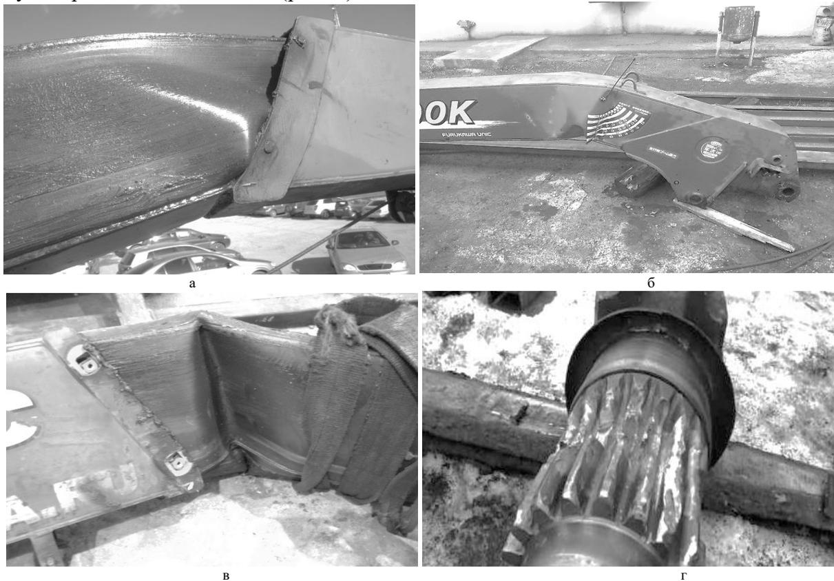
Рис. 1 – Неисправности конструкции манипуляторов: а – излом телескопической секции; б – излом основной стрелы; в – деформация секции телескопической стрелы; г – разрушение шестерни механизма поворота
