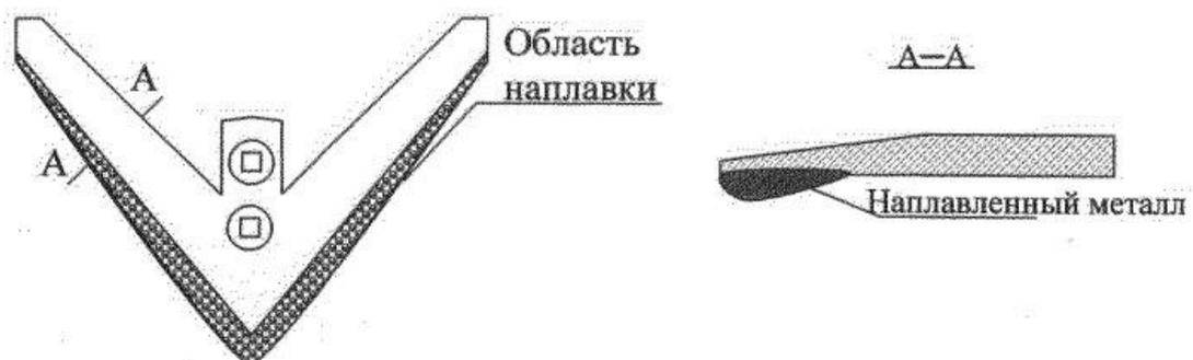
Рис.8. Лапа с наваренным запасом металла с тыльной стороны
