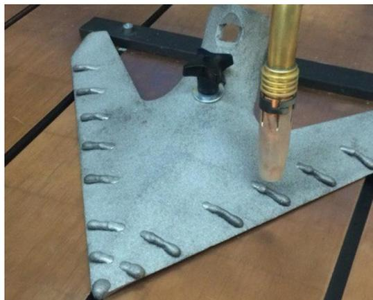
Рис.15. Схема расположения износостойких валиков (а) и наплавленная лапа культиватора (б)
