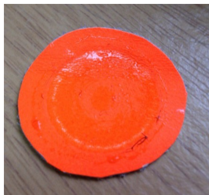
Рис.8. Дослідний зразок НШ на мокре тертя, 100 обертів
