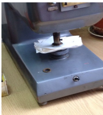
Рис. 7. Випробування зразків на мокре тертя, 100 обертів
