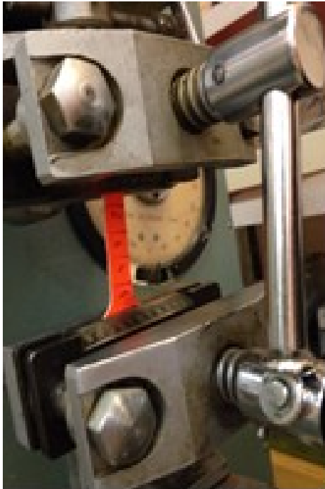
Рис. 3. Випробування зразків на розтяг, розривна машина РТ-250
