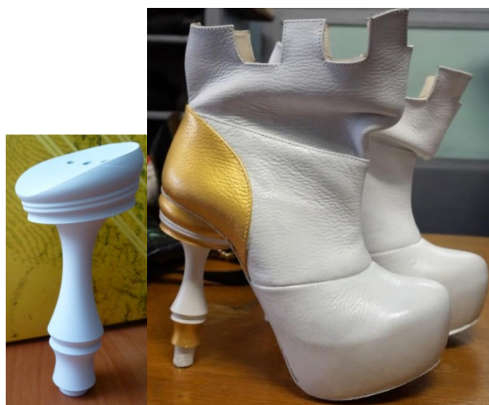
Рис. 17. Виготовлена модель каблука та взуття
