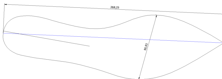
Рис. 9. Створення шаблону сліду колодки в середовищі AutoCAD
