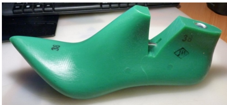
Рис. 12. Колодка, виготовлена на спеціалізованому обладнанні з ЧПК
