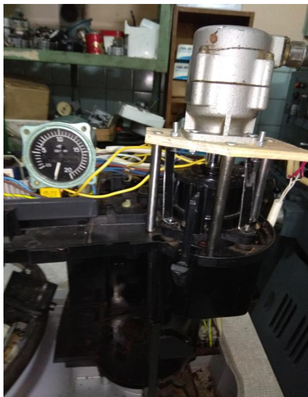
Рис. 2. Лабораторний стенд з автоматичною кавомашиною, яка містить жорнову кавомолку
