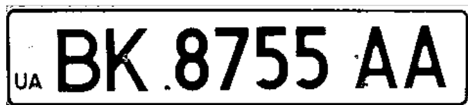
Рис. 8. Бінаризація методом багаторівневого розбиття із підвищеним рівнем розпізнавання 98,4%
